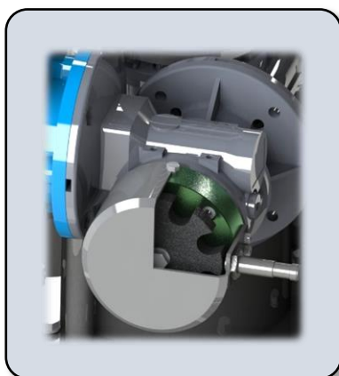
Sistema di regolazione automatico (ruota fonica)
