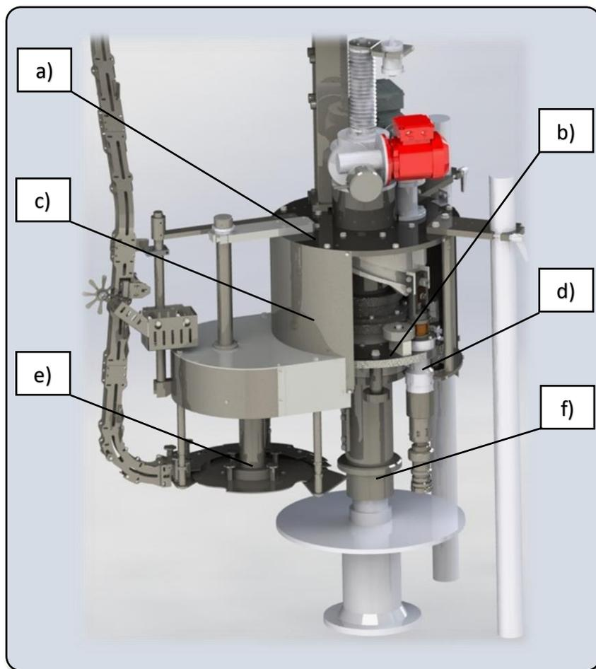
(1) La configurazione washable prevede anche la protezione dei motori elettrici con carterature in acciaio inox aisi 304.
